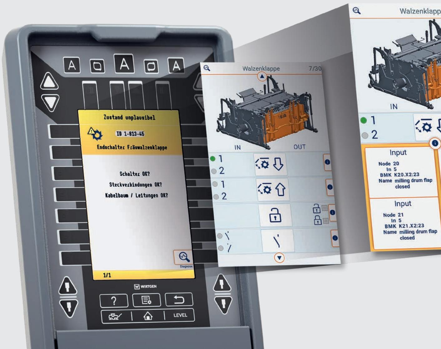
1 | エラーメッセージからの画像を診断システムに、クリアなフォルトロケーション情報と共に直接表示
